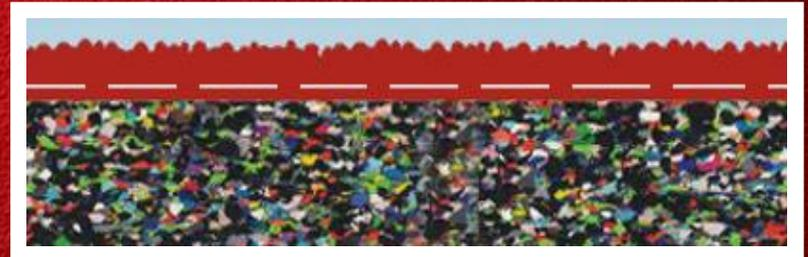
◎ 高强度面层结构有效地控制拉伸变形量，从而控制出合理的垂直变形量。
