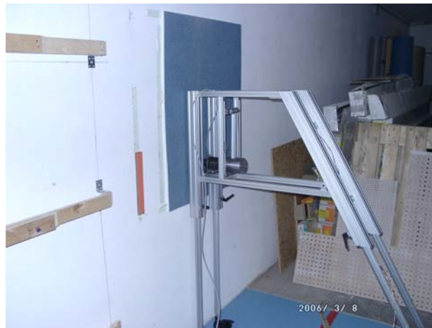
Messung des Kraftabbaus von Prallwänden im Einbauzustand
